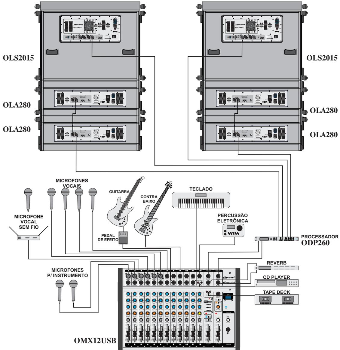
OBS: Os produtos OLA280 e OLS2015 possuem processador de sinal interno, para instalações complexas é indicado o uso do processador Oneal Odp260
